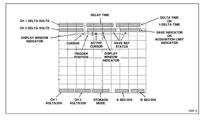
Figure 3-9. Crt readout display.
