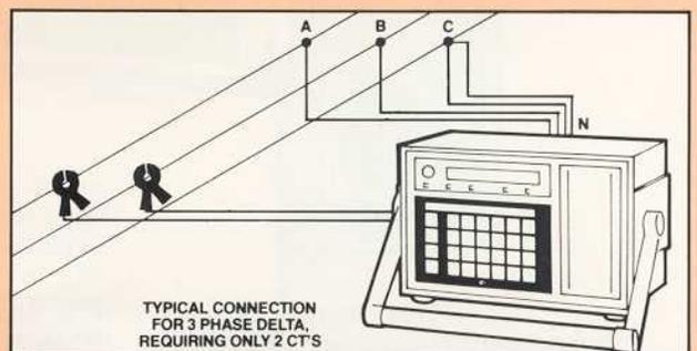
TYPICAL CONNECTION FOR 3 PHASE DELTA, REQUIRING ONLY 2 CT'S
