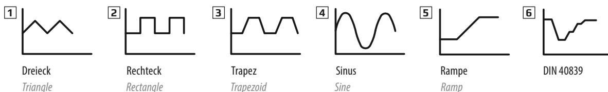
Zusätzlich zu den Standardfunktionen, die auf einem sogenannten Arbiträrgenerator basieren, ist dieser arbiträre Generator offen zugänglich, um komplexe Abläufe für z. B. Produktprüfungen aus bis zu 99 Sequenzen erstellen und ablaufen lassen zu können. Diese Sequenzen können mittels USB-Stick und dem USB-Port am Bedienfeld gespeichert und geladen werden, um so einen schnellen Wechsel zwischen verschiedenen Test- bzw. Prüfsequenzen zu ermöglichen.
