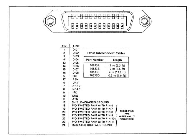
Figure 6-4. HP-IB interfacing
