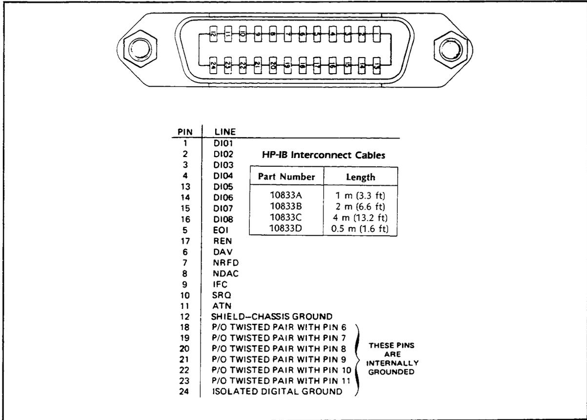
Figure 6-4. HP-IB interfacing
