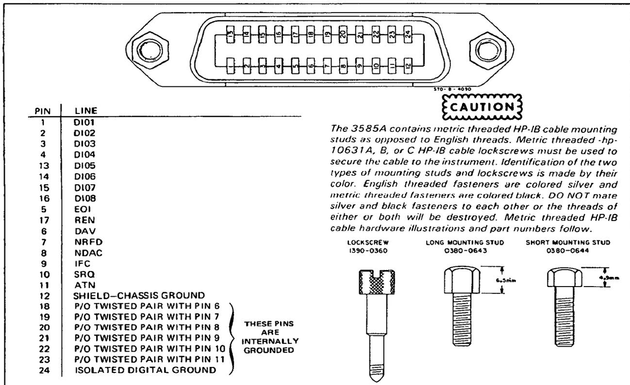
**Figure 2-5. HP-IB Connector.**
