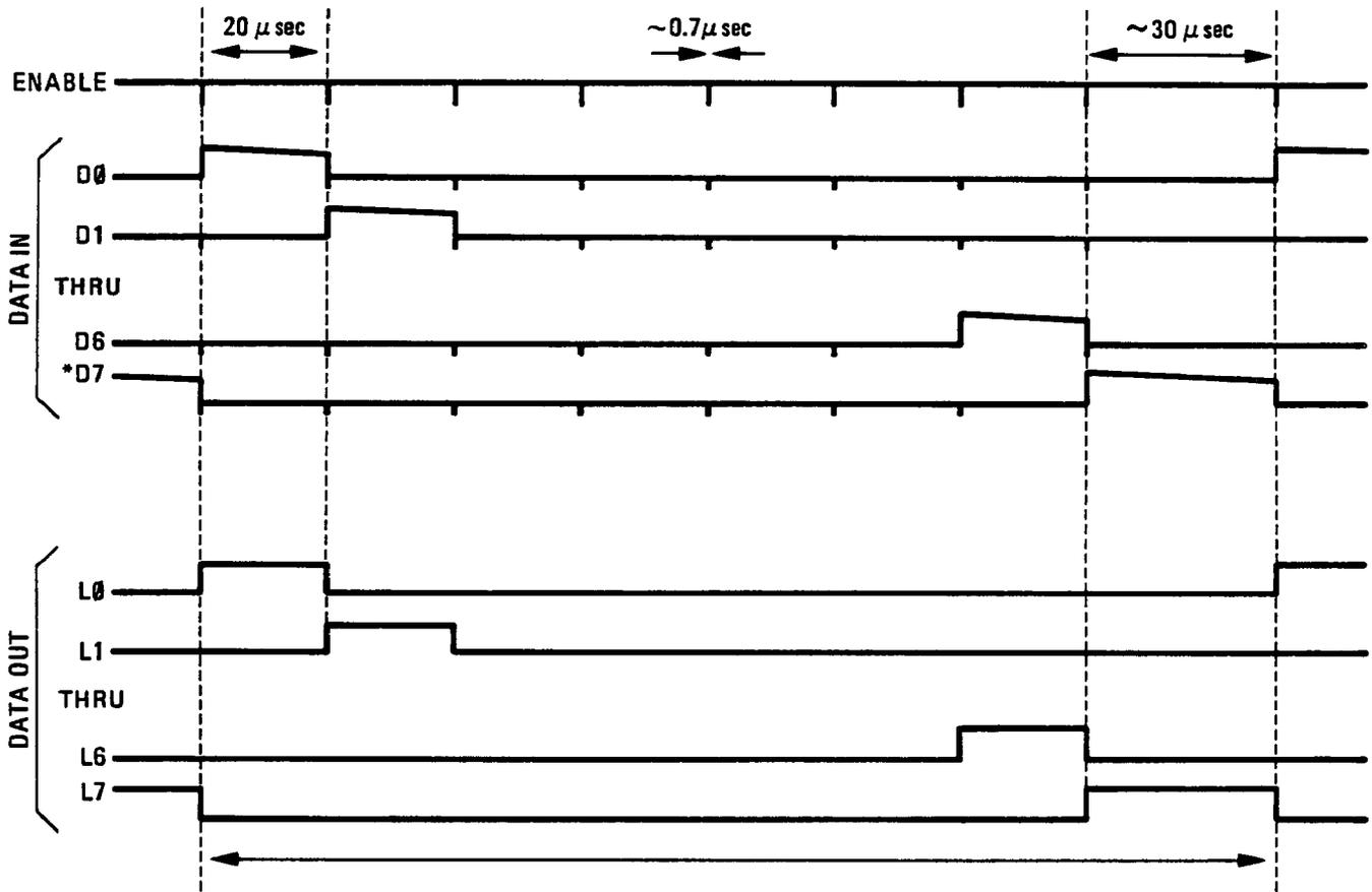
\*DURATION OF LAST BIT PULSE IS APPROXIMATELY 30 μSEC DUE TO DELAY BETWEEN RECYCLE.
