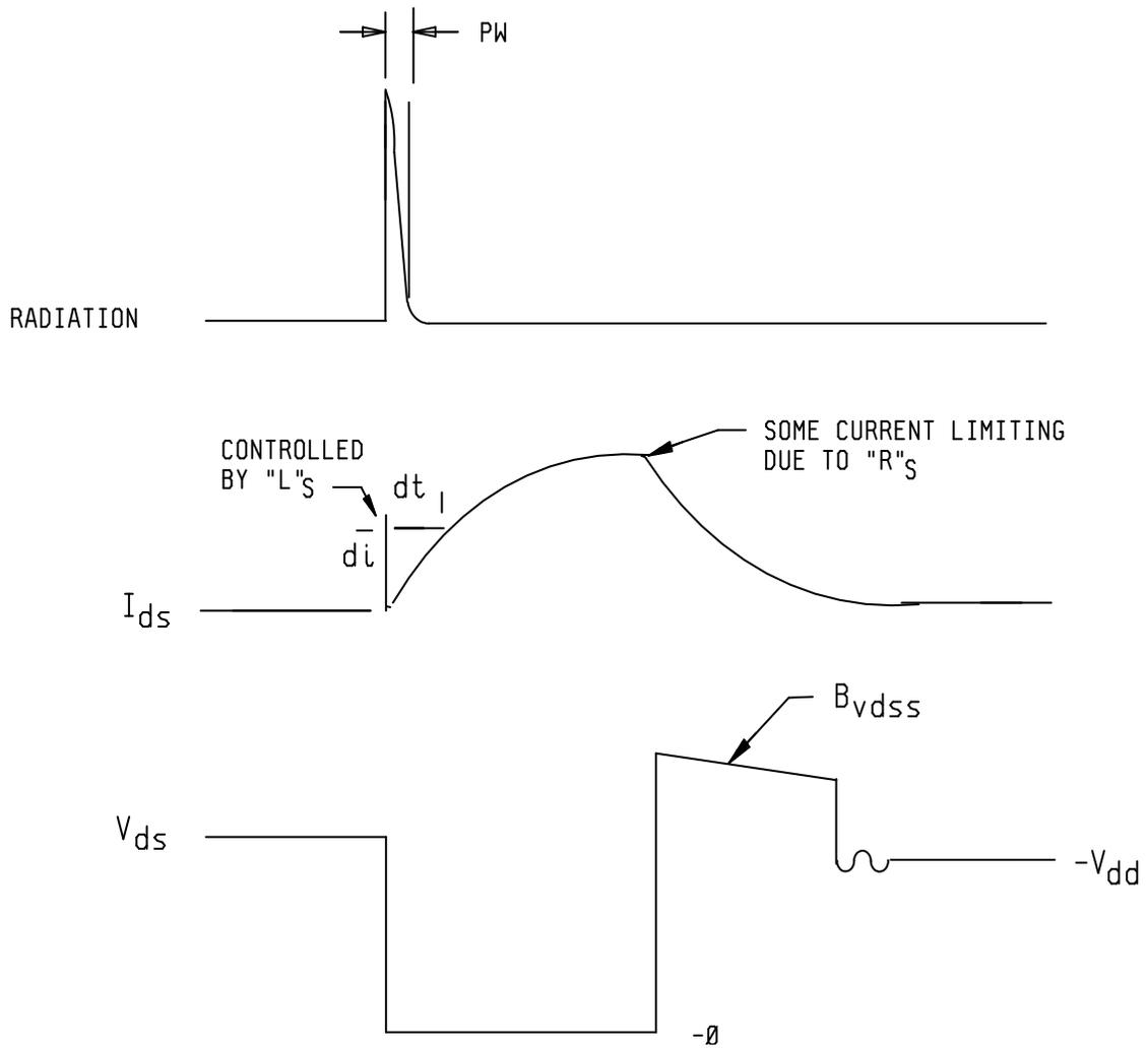
FIGURE 3478-4. Actual test waveforms.
